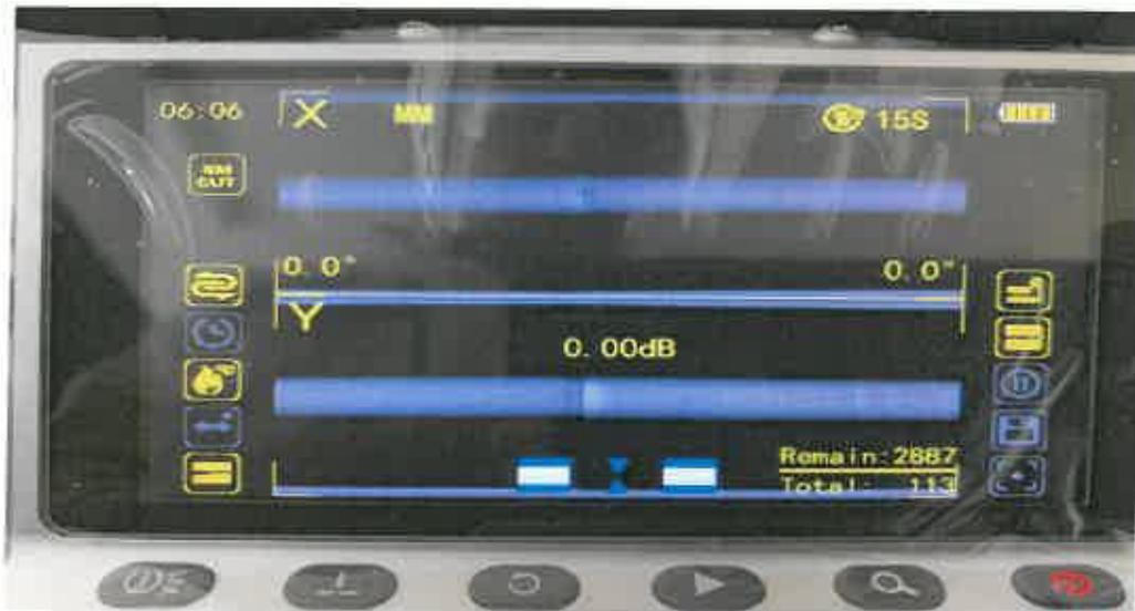
**Medición de la fusión de la Fibra Óptica**
