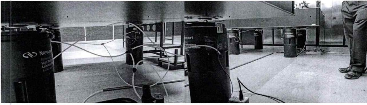
Una vez que las dos mesas quedaron estables, se apago el compresor de aire y se limpiaron los aisladores neumáticos y el compresor de aire con toalla para limpieza y espuma limpiadora, frotando la superficie y removiendo todo el polvo que había en ellos.
